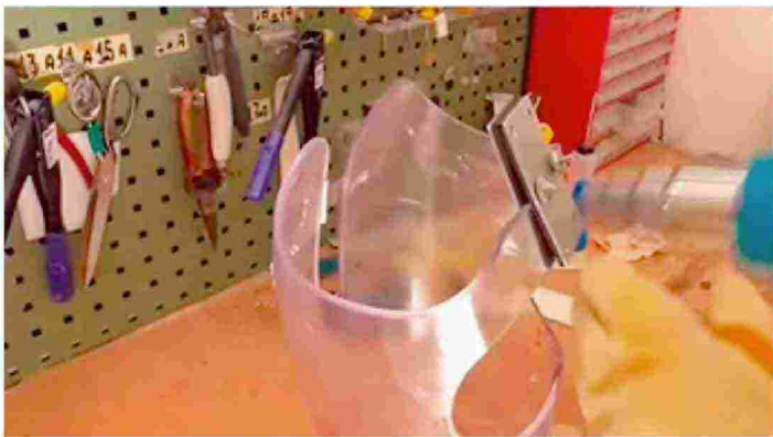
Figura 2. Rimodellamento del cavo anteriore con l'applicazione di un blocco di metallo per evitare la deformazione
